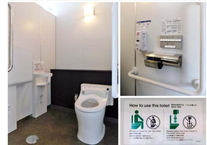
ベビーチェア、ベビーシートを設置したひろびろブース。要所に外国人利用者に配慮して、使い方を4ヶ国語表記したラベルを掲示。省エネの観点から、各ブースに人感センサーの照明を設置している。
