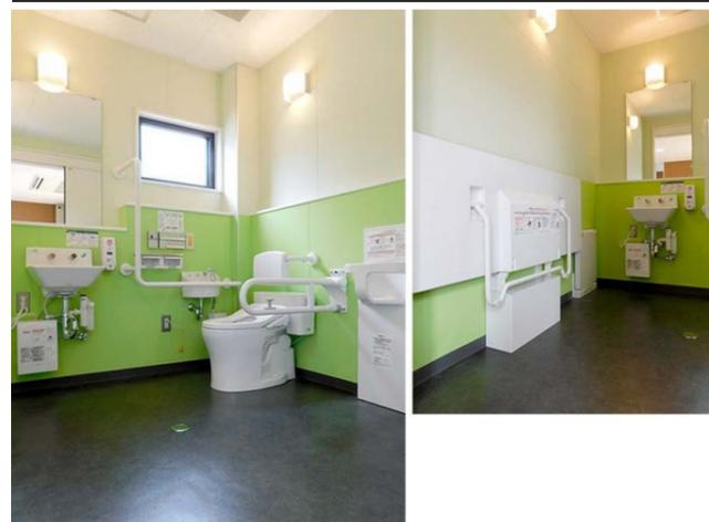
大型ベッド、フィッティングボード、ベビーチェアを設置した左勝手多目的トイレ。コンパクトオストメイトパックは2ヶ所とも設置している。
