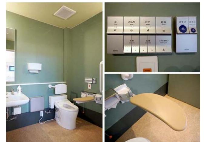
ウォシュレットは、ボタンを押すと自己発電するエコリモコン搭載のウォシュレットアプリコットPを設置。また、便器への移乗、立位保持から座位保持までサポートする前方ボード(スイングタイプ)を設置している。
