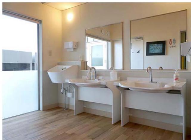
手洗い回数の多いスタッフの腰の負担に配慮したスタッフ用手洗器と、車いすや椅子でアプローチしやすい車いす対応洗面を設置。衛生面と利用者配慮の両面から2種類を併設している。
