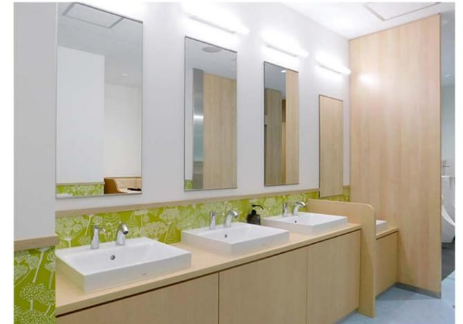
冬でも温かいお湯が使えるよう電気温水器を設置。また、洗面器の内1ヶ所は、お子様の使いやすさを考慮して低めに設置している。
