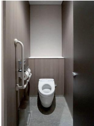
男女トイレとも1ヶ所に車いす使用者、オストメイトが利用できる簡易多機能トイレブースを設置。さらに別の1ヶ所のブースには、L型の手すりを設置しており、利用者が自身で選べる工夫をしている。
